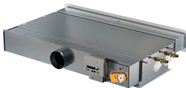
Figur 11. WISE Paragon, komplett med fabriksmonterad styrenhet WISE CU, ställdon, samt ventiler och ventilställdon för kyl- och värmevatten.
