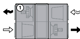
Abluft oben (Rechts-Inspektion)
