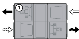
Zuluft oben (Links-Inspektion)
