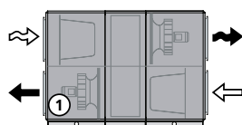
Aire de impulsión hacia abajo (inspección a izquierdas). No hay RX tamaños 004-008 en caja común.
