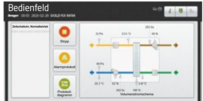
Beispiel für ein Anlagenschema im integrierten Web-Server.
