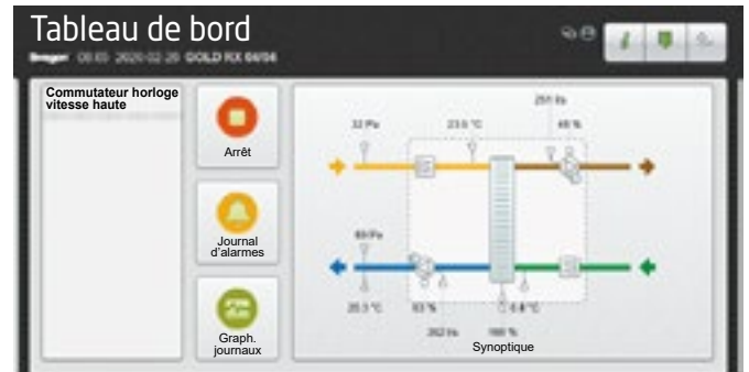
Exemple de synoptique du serveur Internet intégré.
